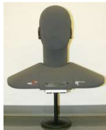
Figura 15 : cabeça acústica utilizada para registrar os ruídos do veículo.
