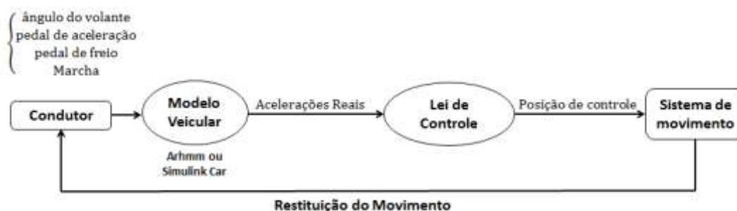
Figura 8 : Esquema simplificado sobre o funcionamento do simulador de direção. A posição de controle é obtida integrando duas vezes a aceleração.
